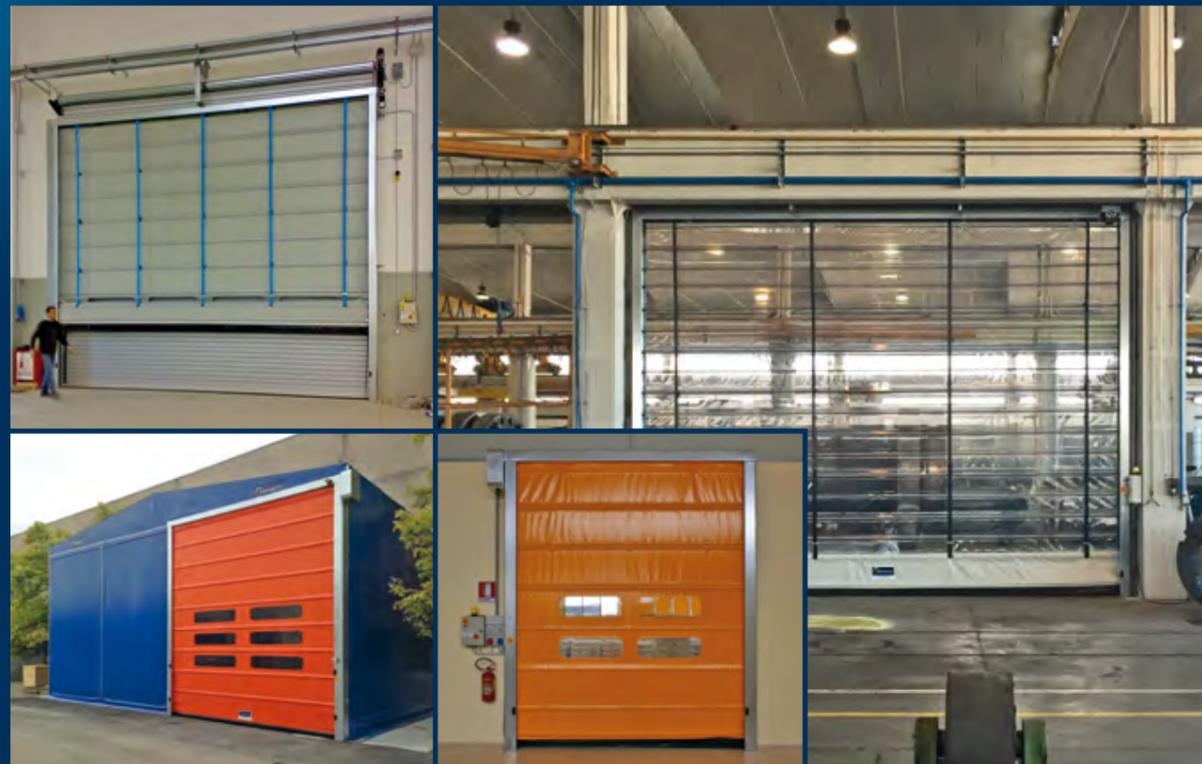
Le porta ad avvolgimento **THUNDER®** è provvista di un sistema a tenuta laterale in materiale polimerico autolubrificante che permette l'auto-riparabilità e un maggiore isolamento termico, garantito anche dal manto unico realizzato in tessuto poliestere biplasmato in ordito e trama di 1300 gr/mq.
