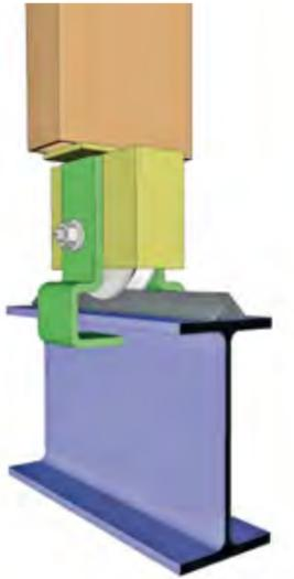
*Le capriate della struttura scorrono grazie a ruote in acciaio con doppio cuscinetto a sfera su binari posti in entrambi i lati su guide ancorate su pilastri.*
